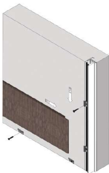
Installazione pannello iniziale Boiserie-H Installation of the starting panel Boiserie-H
