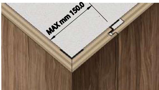
Pannello assemblato a 45° con un lato di dimensione max 150 mm e con un rinforzo in alluminio
