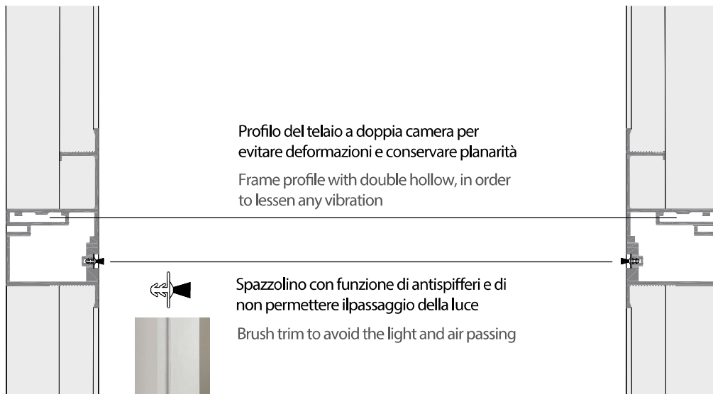
Traverso predisposto per l'inserimento della cerniera a bilico Beam prearranged for pivot hinge
