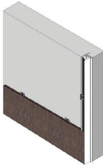
Ancoraggio pannello iniziale Boiserie-H Anchor of the starting panel Boiserie-H
