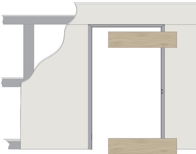
Solo dopo che il telaio è stato fissato in modo solido e definitivo togliere i 2/3 pannelli in OSB e procedere al fissaggio delle lastre in cartongesso e alla rasatura finale della parete.
