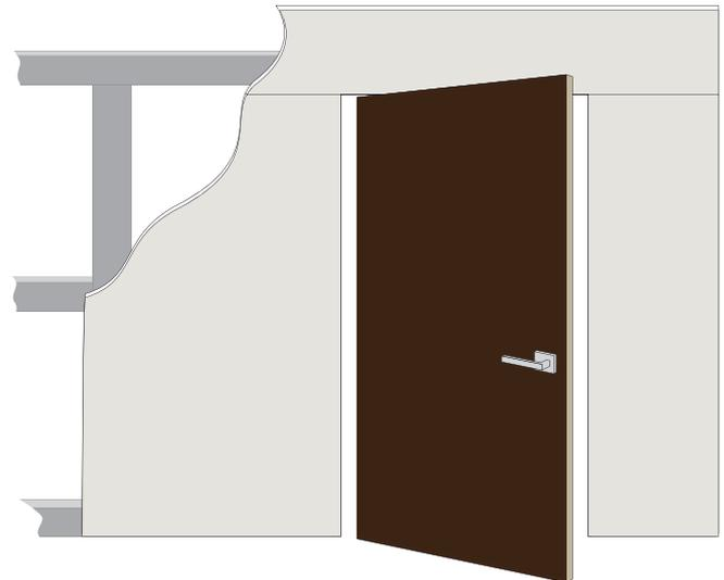
Installare la porta e verificare la sua planarità attraverso la regolazione delle cerniere.
