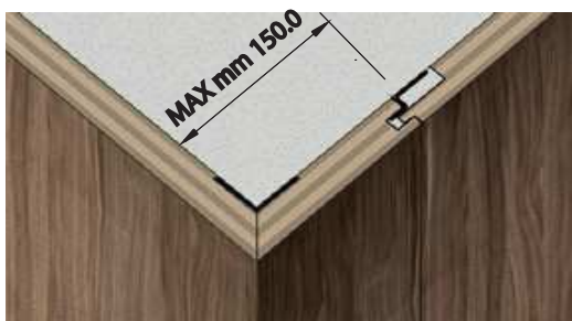
Pannello assemblato a 45° con un lato di dimensione max 150 mm e con un rinforzo in alluminio
